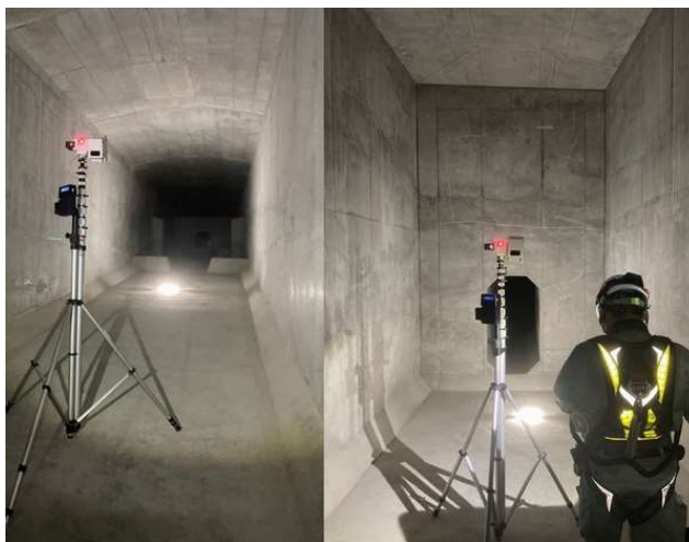
橋梁点検ロボットカメラ (NETIS 登録番：KT-160016-VE)
