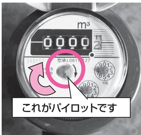
蛇口を全部閉めて、水道を使っていない状態で、メーターのパイロットが回っていないか確認してください。回っていたら、漏水していると思われます。
